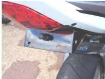
**HINWEIS: VOR DER MONTAGE MUSS DIE LICHTABDECKUNG MIT SEKUNDENKLEBER AN DER LED-KENNZEICHENBELEUCHTUNG ANGEKLEBT WERDEN.**
