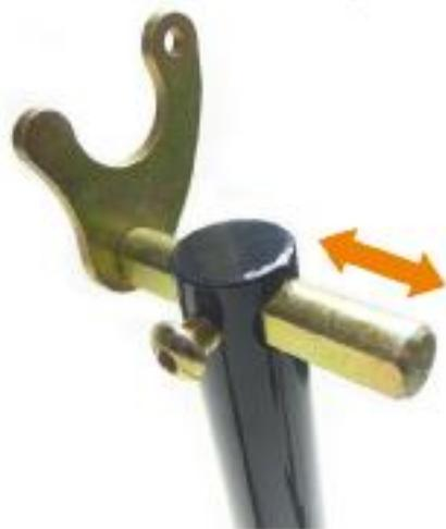
Insérez le support de façon à avoir le méplat de la tige côté vis pour éviter le pivotement.
